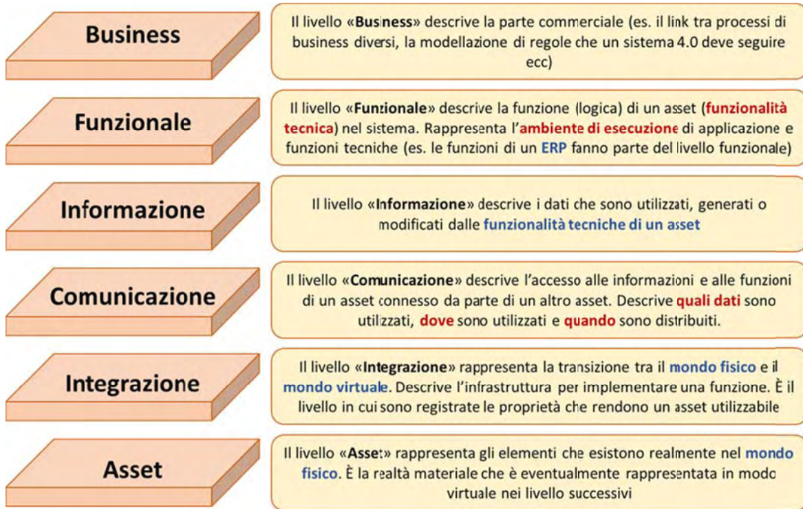
Fig. 3.2.2. Layer del RAMI4.0 per tradurre un asset fisico nel suo duale digitale.
