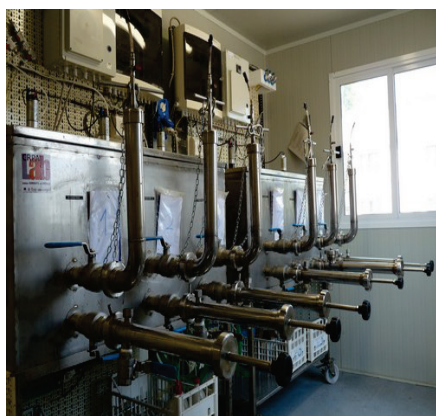
Figura 5 Sistema in continuo per la misura del potenziale metanigeno delle biomasse di scarto
